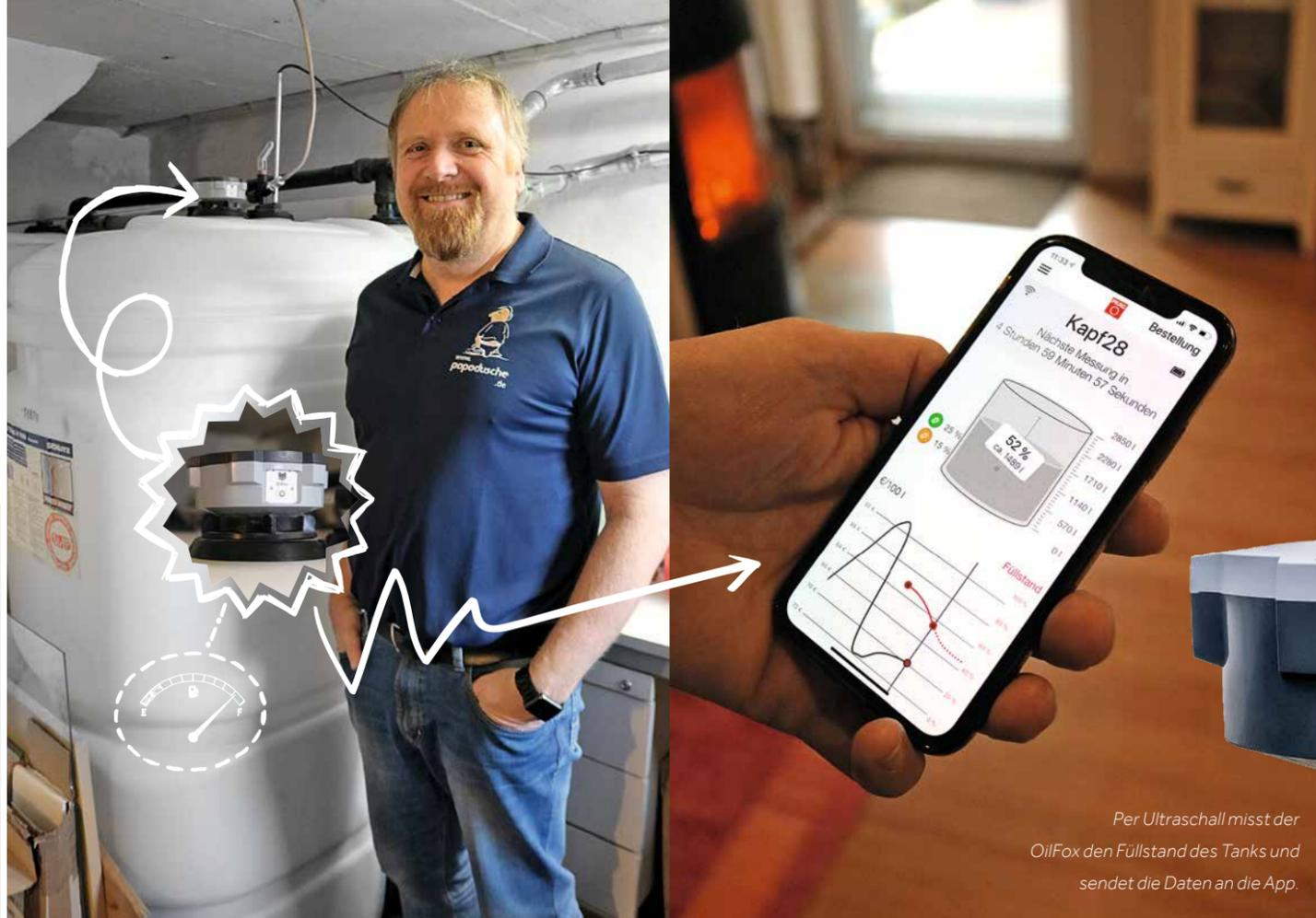
Per Ultraschall misst der OilFox den Füllstand des Tanks und sendet die Daten an die App.
